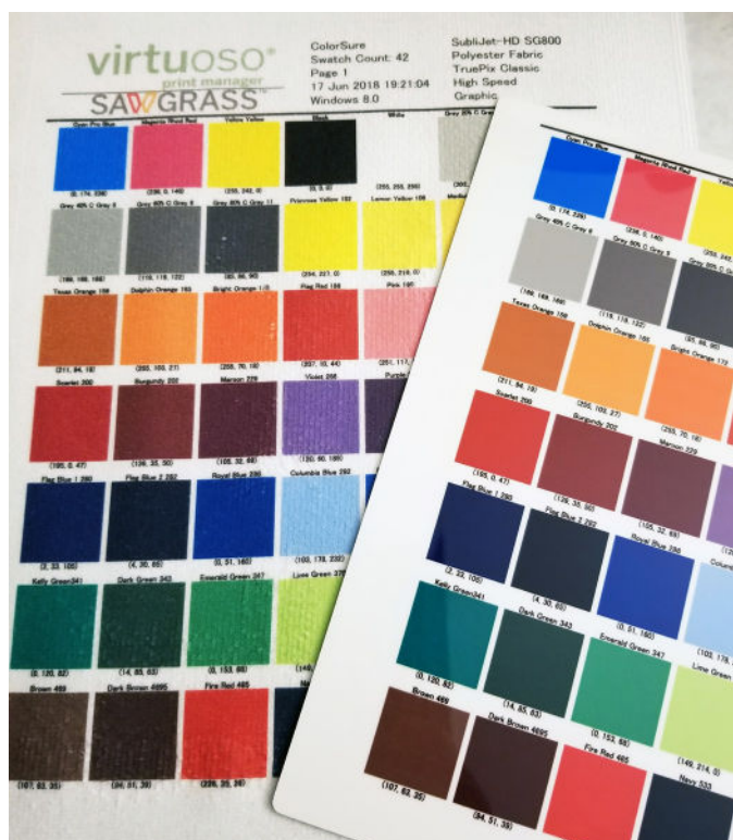
La palette illustrée à gauche a été pressée sur une serviette de sport en polyester, tandis que celle de droite a été produite sur un panneau photo ChromaLuxe blanc.
